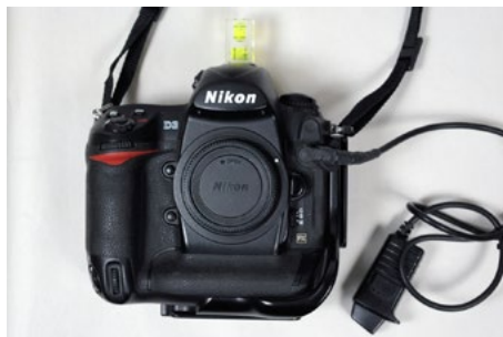
De gauche à droite: Rotule + kit panoramique par assemblage Really Right Stuff, Nikon D3 équipé d'un niveau à bulle, d'un déclencheur électrique et d'une embase de fixation horizontale/verticale de type Arca-Swiss, fabriquée par Really Right Stuff, un petit disque dur 2.5" Western Digital My Passport avec sa prise USB et une carte mémoire Sandisk de 16 GB.
